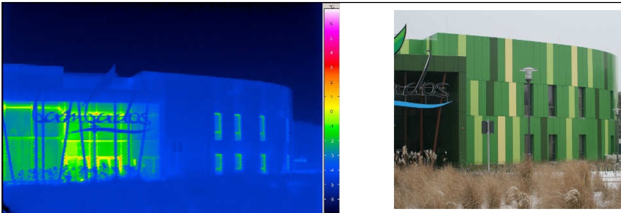
Abbildung 33: Thermogramm und Lichtbild der Außenfassade vom Eingangs- sowie Verwaltungsbereich
