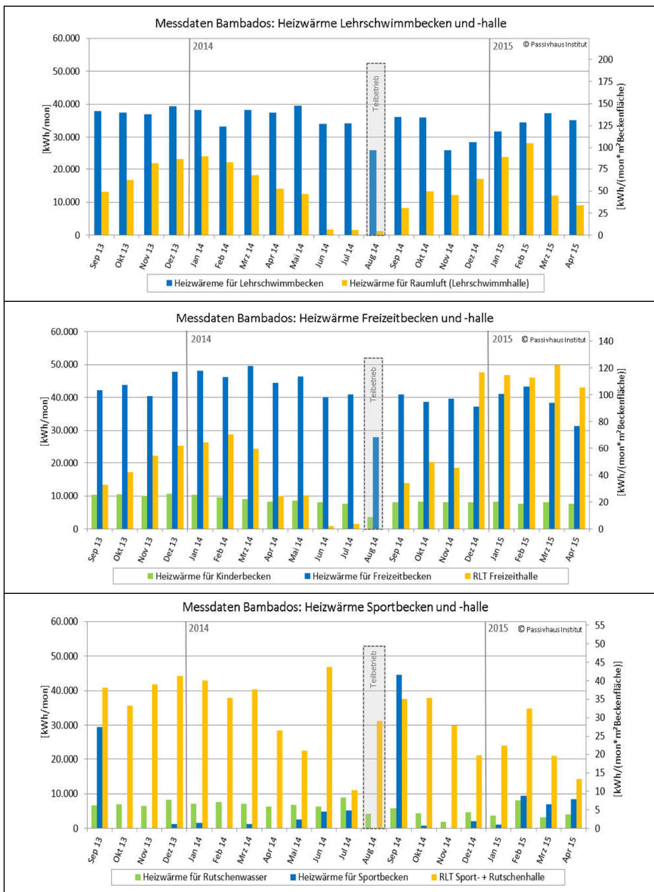
Abbildung 16: Vergleich des Heizwärmeverbrauchs für Becken und Raumluft aufgeteilt auf die drei Hallenbereiche. (Die linke y-Achse mit den Absolutwerten ist in allen drei Diagrammen gleich skaliert, auf der rechten y-Achse ist jeweils der Verbrauch pro m² Beckenfläche dargestellt.)
